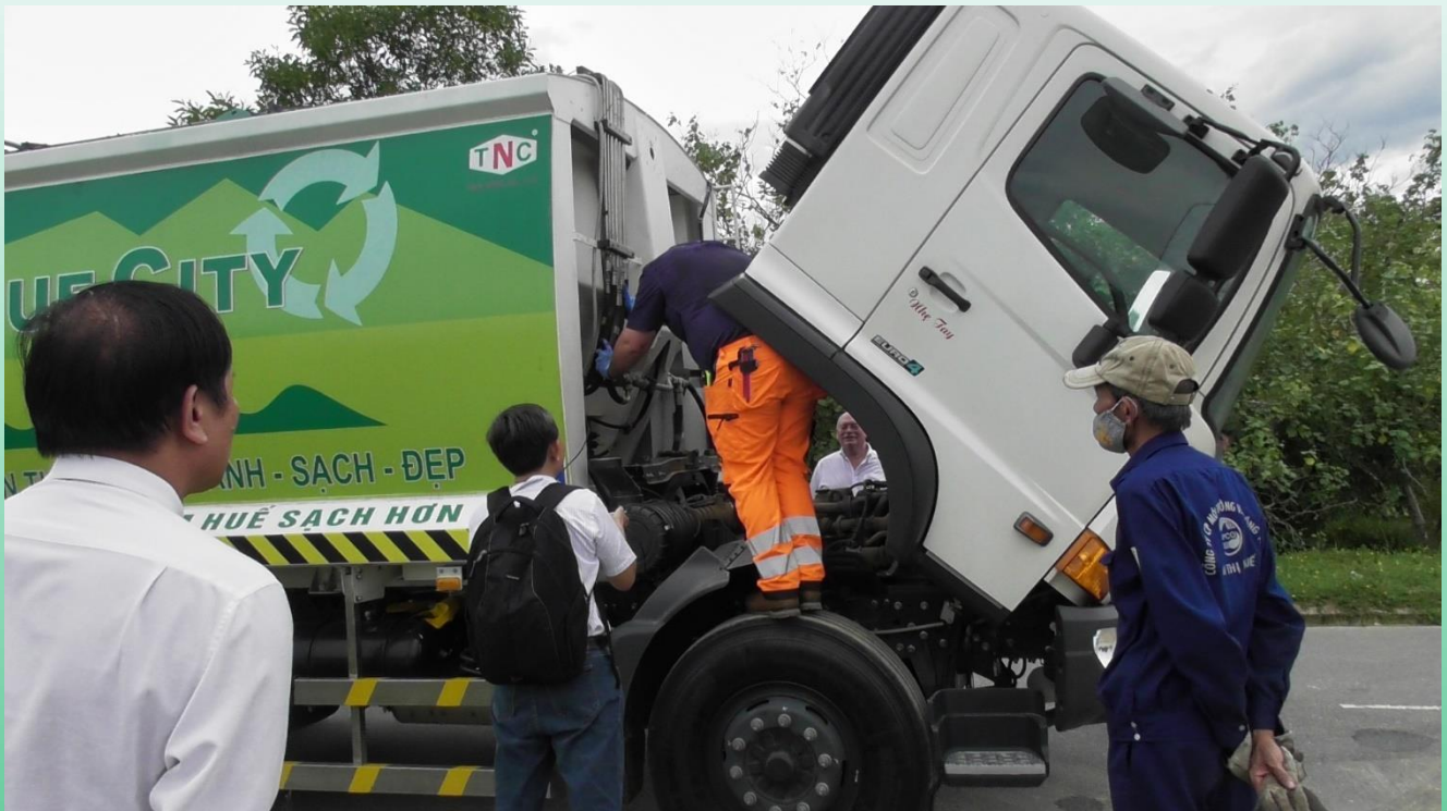
(Các chuyên gia của Terberg đến Việt Nam để trực tiếp bảo trì, bảo dưỡng xe ép rác 3 trong 1 cho khách hàng)
