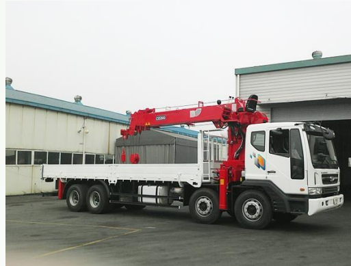
Xe cẩu để lắp đặt thiết bị
