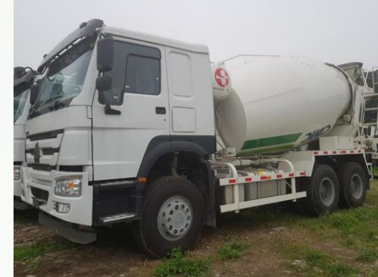
Xe trộn bê tông để làm kín hố và thiết bị
